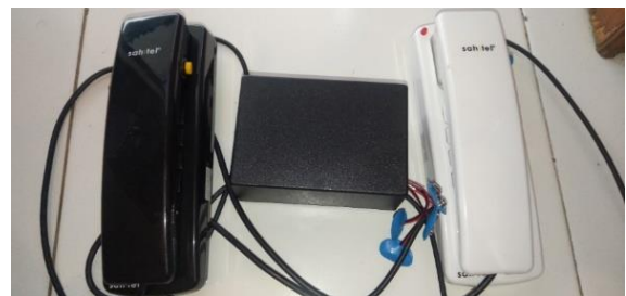
Gambar 4. Pengemasan simulasi interkom 1 kanal menggunakan IC LM386 tampak depan
