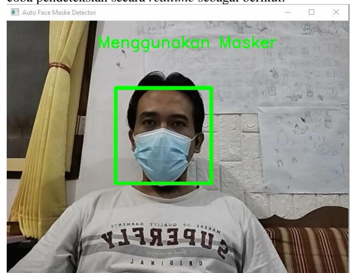
Gambar 2. Prototipe mendeteksi objek wajah yang memakai masker
